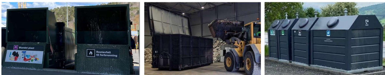
Figur 3: Eksempler på ulike typer lukkede containere: komprimator for restavfall m.m. (venstre); containere med lokk for hageavfall m.m. (midten); bunntømt containere for glass og metall (høyre). (Kilde: ReMidt)
